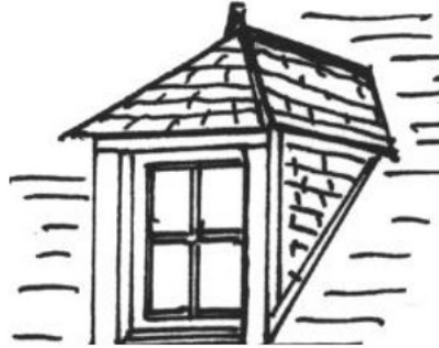
La lucarne à capucine Avec trois pans de couvertures
